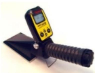
RadEye AB 100 поисковый дозиметр
